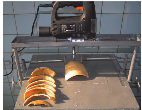
Рис. 3. Устройство для изготовления костных срезов: 1 – вибрационно-стойкий каркас; 2 – п-образная платформа; 3 – электролобзик; 4 – сменная пилочка электролобзика; 5,7 – боковые держатели; 6 – центральный держатель; 8 – вырез в платформе для прохождения пилочки; 9, 12, 13 – штативы; 10 – фиксатор.
