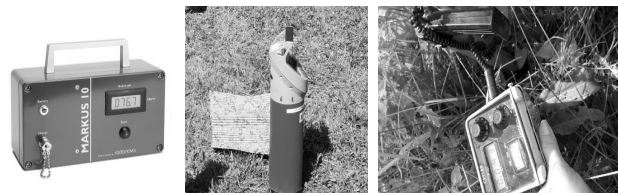
Figura 1. Echipamente moderne de monitorizare a radioactivității naturale din sol și a ratei dozei gamma: emanometrul "Markus 10", spectrometrul gamma cu detector "Gamma-Ray GPX-21A" și radiometrul "CPP-88H"
