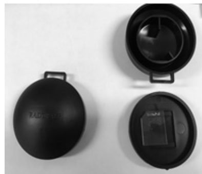
Figura 3. Detector RADTRAC 2 de măsurare a concentrațiilor de ^{222}\text{Rn} în locuințe pe termen lung – de la 2 luni până la 1 an
