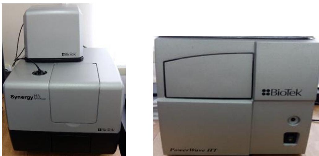
Figura 12. Spectrofluorimetrul cu microplăci Synergy H1 (Hybrid Reader, SUA) și spectrofotometrul PowerWave HT (BioTek Instruments, SUA)
