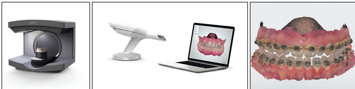
Fig.4. Colectarea datelor pentru planificarea virtuală, digitalizarea arcașelor dentare. A) Scanner de laborator. B) Scanner intraoral. C) Arcade dentare scanate utilizând scanner intraoral Trios 3 (3Shape). Imaginile A,B preluate www.3shape.com , C, cazuistica Omni Dent.
