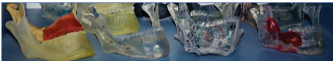
Fig.7. Modele anatomice individualizate printate 3D utilizând tehnologia SLA și DLP.
