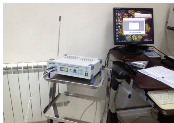
Fig. 1. Analizatorul laser-Doppler al microcirculației sangvine LAKK-02, SPE „LAZMA“, Rusia
