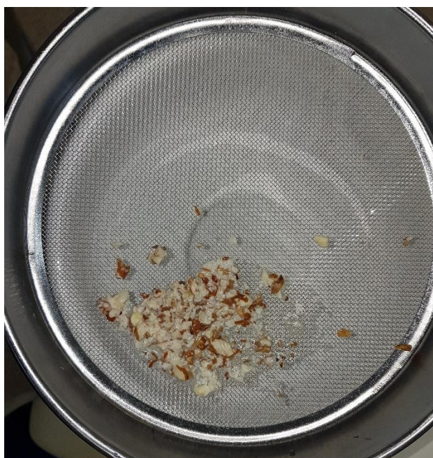
Figura 11. Sită metalică Nr.12. Diametrul găurilor 1.68mm. Standardul ISO 565/3310-1.
