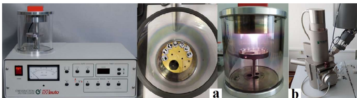
Figura 5.13. Acoperirea probelor cu strat subțire de aur în dispozitivul Cressington Sputter Coater 108 auto (a) și microscopul pentru scanarea electronică Vega 5130, Tescan (b).
