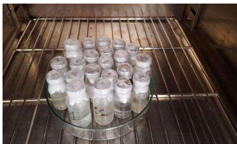
Figura 5.15. Probe de țesut osteocondral în incubator în timpul testului de degradare enzimatică.
