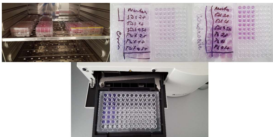
Figura 5.10. Efectuarea testului de citotoxicitate cu MTT.
