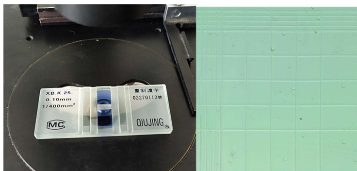
Figura 3.4. Numărarea celulelor prin excludere cu soluție de 0.4% albastru de tripan.
