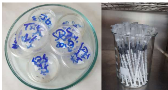
Figura 5.14. Pregătirea probelor și realizarea testului de umflare.
