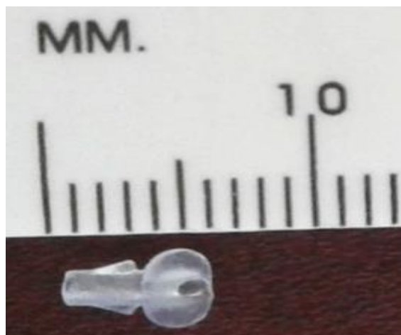
Figura 4. Șuntul cu supapă antiglaucomatoasă elaborat ( model ES 1 )
