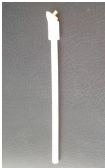
Figura 4. Șuntul cu supapă antiglaucomatoasă elaborat ( model ES 1 )
