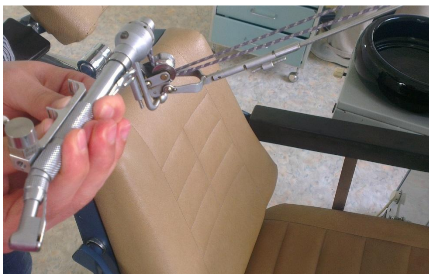
Fig.3. Măsurarea vibrațiilor la piesa unghi pentru braț dur
