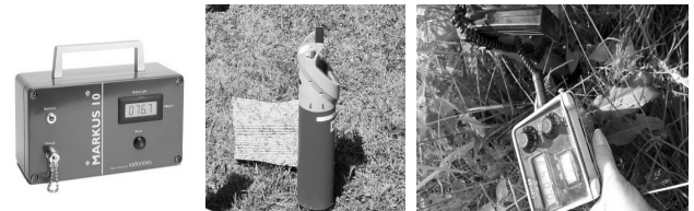
Figura 1. Echipamente moderne de monitorizare a radioactivității naturale din sol și a ratei dozei gamma: emanometrul "Markus 10", spectrometrul gamma cu detector "Gamma-Ray GPX-21A" și radiometrul "CPP-88H"
