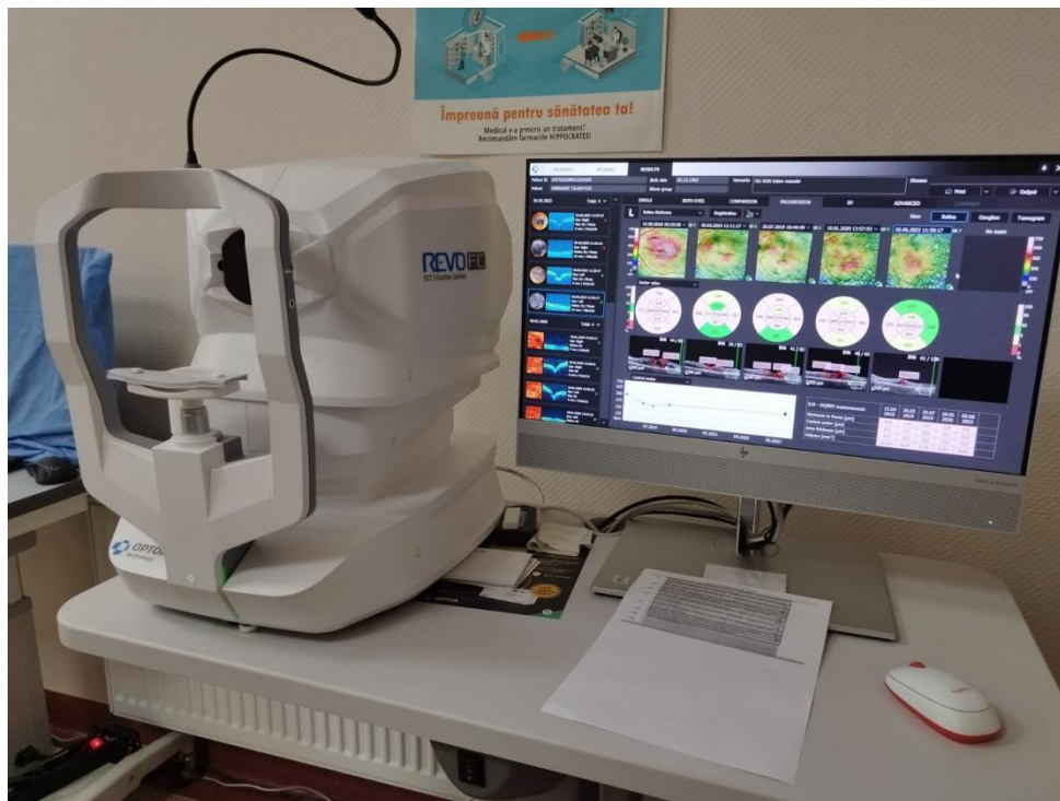
Figura 2.8. Aparat pentru Tomografie în Coerența Optică (OCT) pentru toate elementele globului ocular, OCT – Angiografie noncontrast (fără substanță de contrast).
