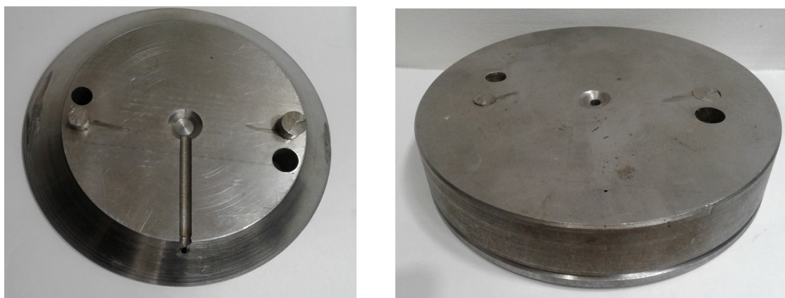
Foto. 2b. Formele - matriță a șuntului cu supapă
