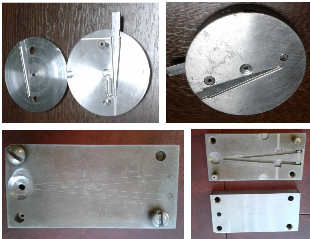
Foto. 2b. Formele - matriță a șuntului cu supapă
