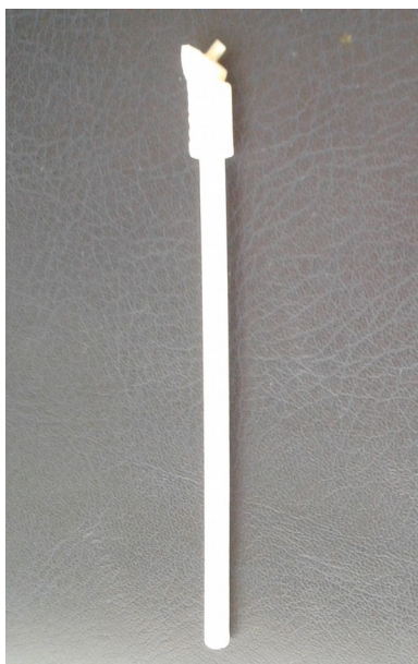
Pensă chirurgicală cu șunt antiglaucomatos pentru implantare (executat prin 3D printer)–model 2
