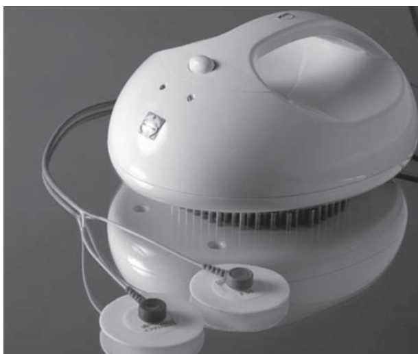
Фиг. 1. Электроимпедансный компьютерный маммограф
