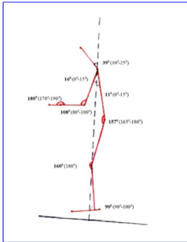
Figura 4. Prezentarea goniometrică a poziției de muncă a operatorului din secția de șpritzare
