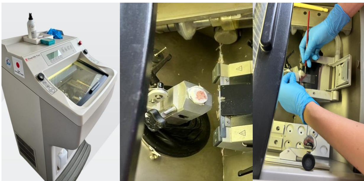
Figura 7. Procedura de obținere a secțiunilor „la gheață” cu ajutorul criostatului cu microtom rotativ Tissue-Tek Cryo3 și etalarea pe lama de sticlă
