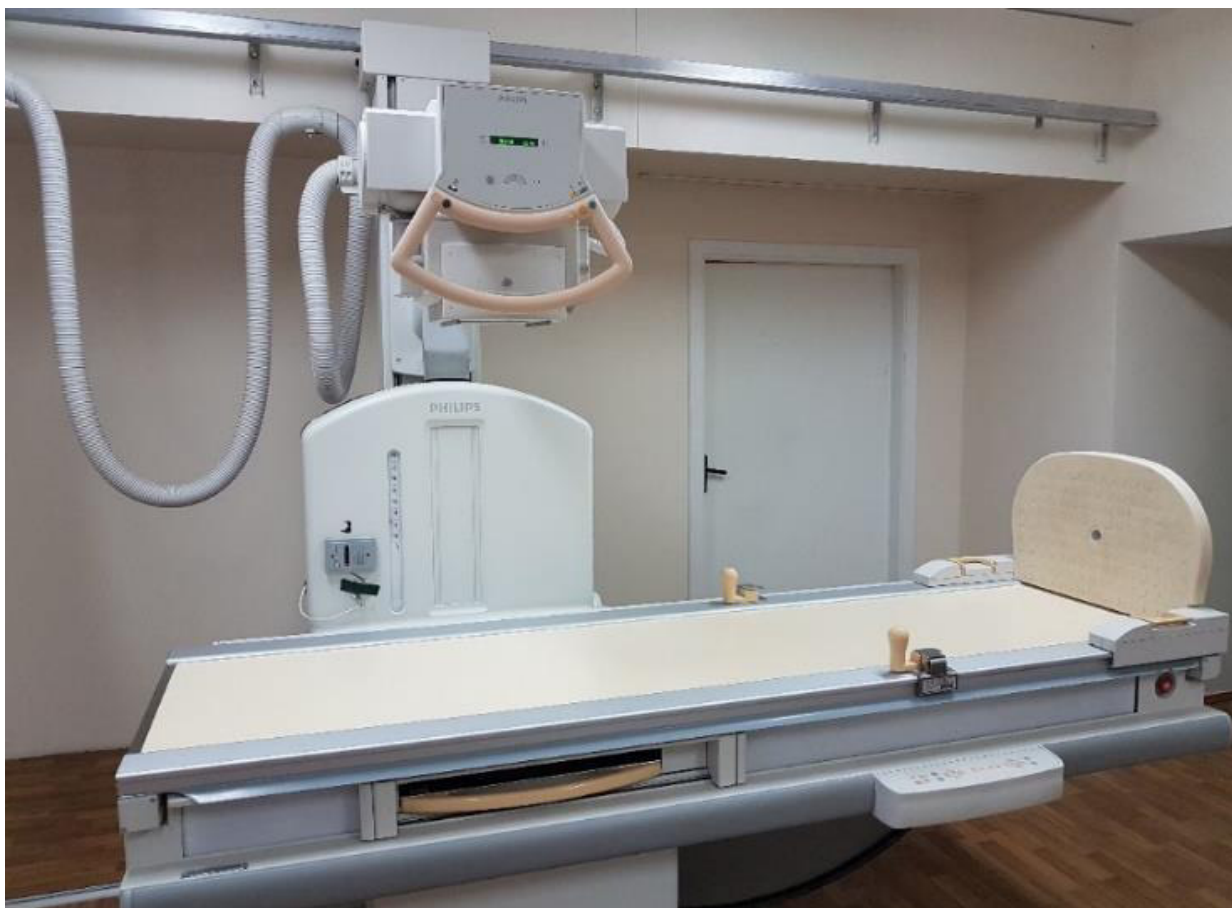
Figura 2.5. Aspectul aparatului pentru examinarea pacienților prin metoda Radiografiei Digitale și tomograma liniară (aparat folosit în CCD IMSP IO)
