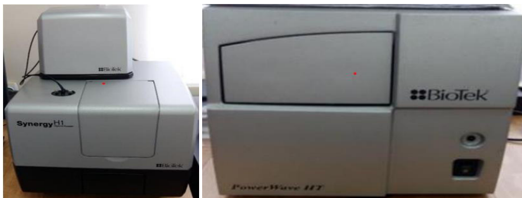
Figura 2.3. Spectrofluorimetrul cu microplăci Synergy H1 (Hybrid Reader, SUA) și spectrofotometrul PowerWave HT (BioTek Instruments, SUA).
