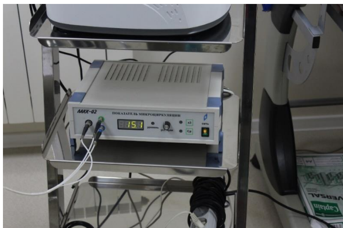
Fig. 2.5. Analizatorul laser-Doppler al microcirculației sangvine LAKK-02, SPE “LAZMA”
