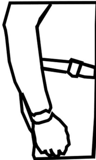
Figura A.2.74 Locațiile accelerometrului în talie și încheietura mâinii drepte: GT1M și GT3X+ (accelerometrele adiacente și GENEa lipit de GT1M, poziționat deasupra soldul drept; GENEa la încheietura mâinii drepte) [Rowlands A.V., Stiles V.H. Accelerometer counts and raw acceleration output in relation to mechanical loading. Journal of Biomechanics 45 (2012)]
