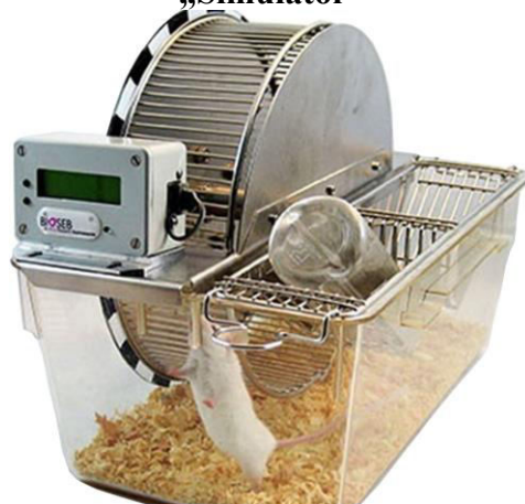
Figura A.2.3 Model experimental „Muncă în ture de noapte” (cușcă rotativă promovează activitate motorie forțată a unui animal în timpul perioadei de odihnă și somn)
