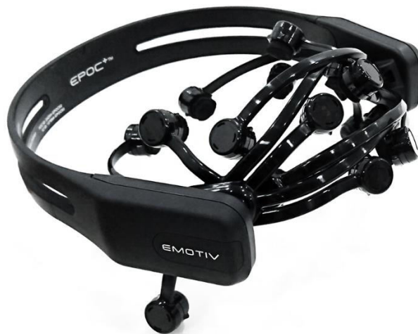
Figura A.2.69 Un dispozitiv portabil îmbunătățit pentru înregistrarea EEG în timp real în timpul activității zilnice (EMOTIV)
