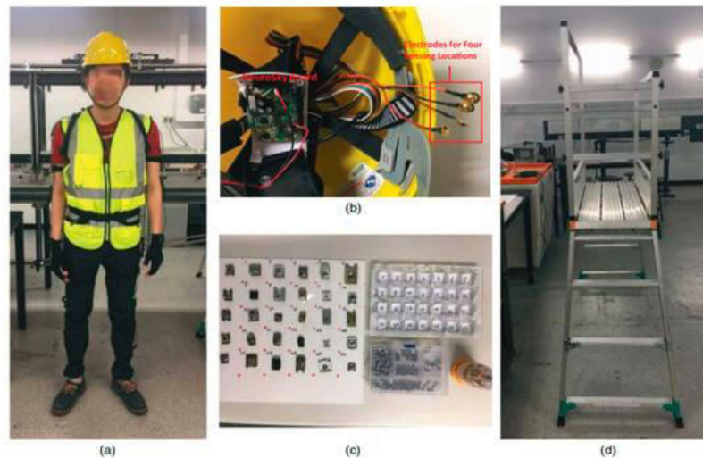
Figura A.2.71 Aparat experimental: (a) subiect de experiment; (b) casă EEG și cipurile de monitorizare EEG; (c) piulițe și șuruburi; (d) platformă cu scară [Wei B. et al., 2024]
