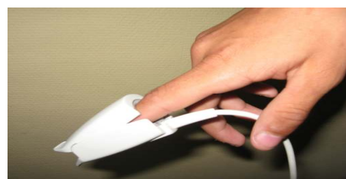
Desen 2. Electrocul pulsoximetrului pentru deget
